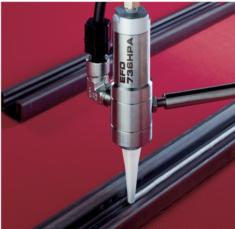
Das Edelstahl-Kolbenventil mit Druckausgleich produziert gleichförmige Dosierungen pastöser Werkstoffe wie Fette und Silikone bei einem Materialdruck bis zu 172 bar (2500 psi).
