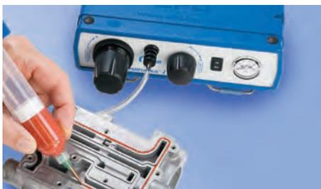
用于不需要定时出胶的操作员控制的点胶应用, Performus I 点胶机适用于所有流体的打点、划线和填充应用。配有电动脚踏板和真空控制装置, 可防止稀薄流体的滴落。
