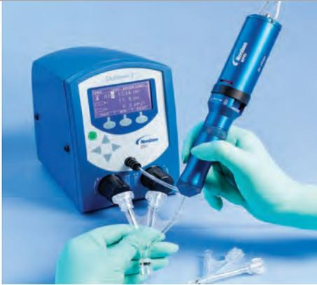
用于RTV硅胶、环氧胶、医用黏合剂以及其他黏厚流体穿过小到0.004英寸直径的点胶针孔。应用于同EFD气动点胶机一起工作。这些工具将点胶机的100psi输出压力放大至最大7倍，从而点胶压力最大可达到700 psi。
