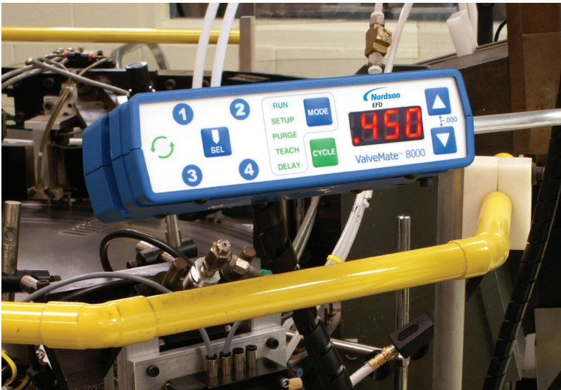
Os controladores ValveMate fornecem o controlo primário do tamanho do depósito.
