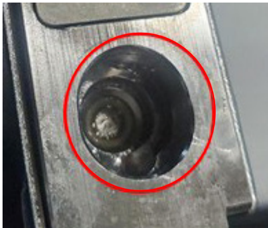
Beispiele für Pulse -Ventilantriebe mit UV-Kleberschmutzung in der Schubstangenkavität
