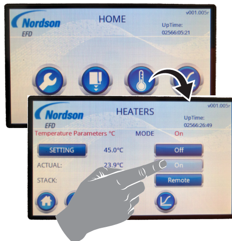
Einschalten der Heizsteuerung
