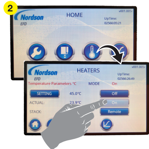
Einschalten der Heizsteuerung
