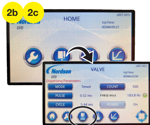
Posição do botão PURGAR (é apresentado o ecrã VÁLVULA do controlador Touch padrão)
