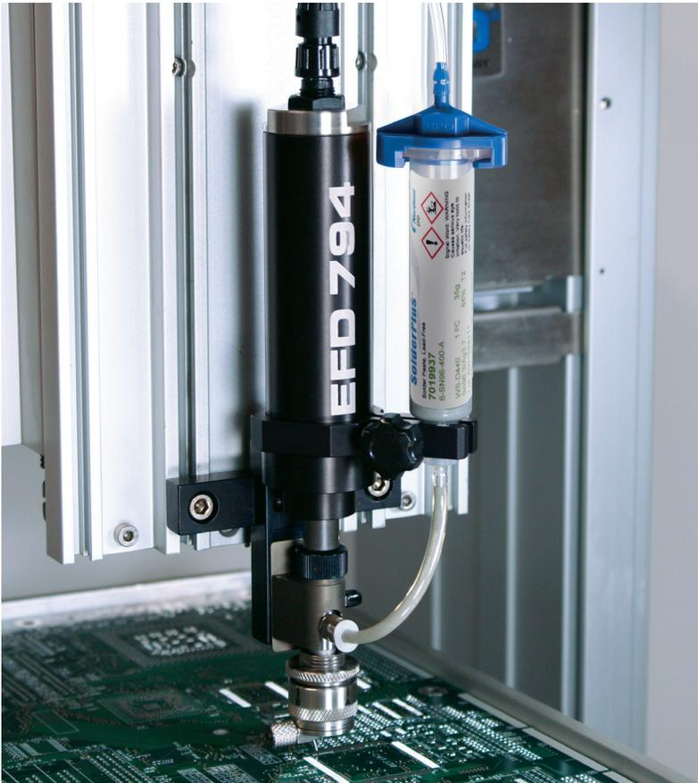
794 Spindelventil bei der Dosierung von EFD-Lotpaste.
