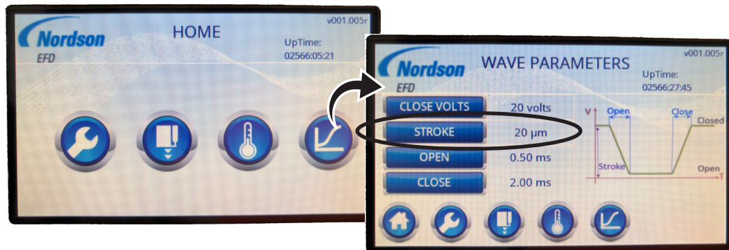
Pantalla PARÁMETROS DE ONDA en el controlador Touch XP (las unidades de CARRERA se ajustan en micras)
