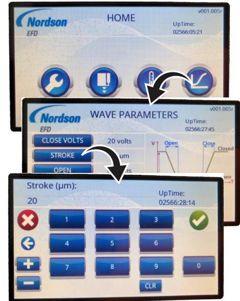
Ajuste el valor CARRERA del perfil de onda habilitado (Controlador Touch XP)
