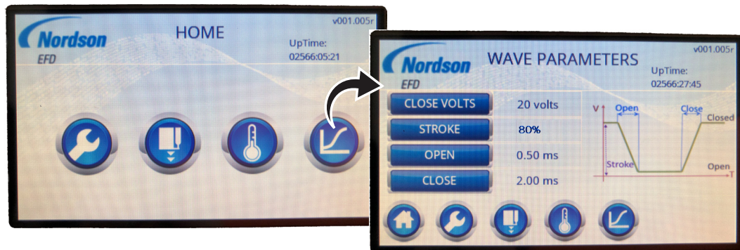
La pantalla Parámetros de onda en el controlador Touch estándar (las unidades de CARRERA se ajustan en un porcentaje de VOLTS CERRAR)
