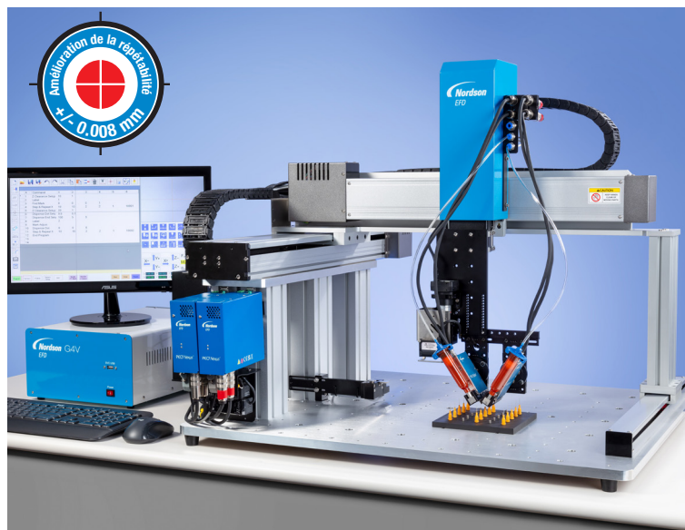
La solution de la série GVPlus offre des doubles brides de montage avec un support de bras supplémentaire, ce qui réduit les vibrations et améliore le rendement.
