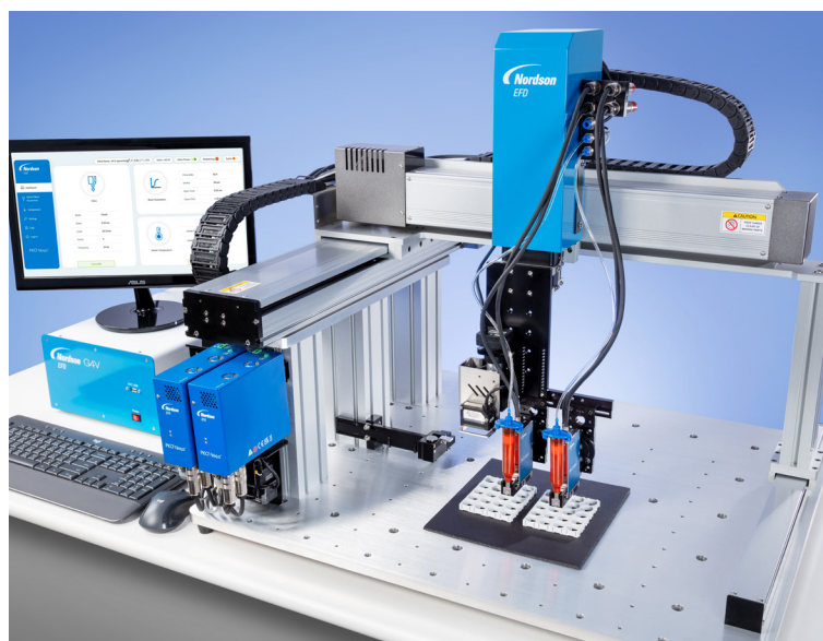
Les améliorations techniques apportées à la solution GVPlus permettent au produit de fournir une précision de positionnement et une répétabilité de dépose à \pm 0,008 mm / 8 \mu m.
