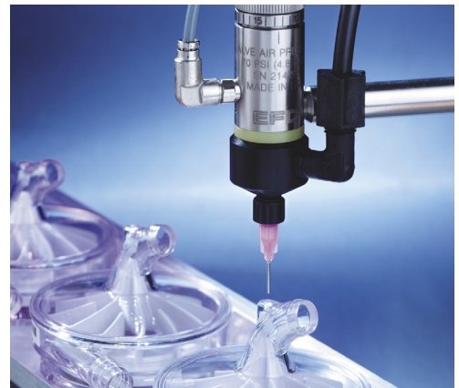
使用752V胶阀在医用泵上点涂UV固化胶。
