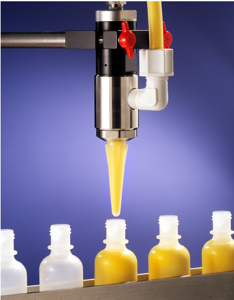
Das 725HF-SS Ventil mit hohem Durchfluss dosiert Farbe in Flaschen.
