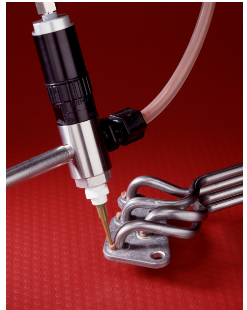
725D applica pasta per brasatura su tubi di trasmissione per automobili.
