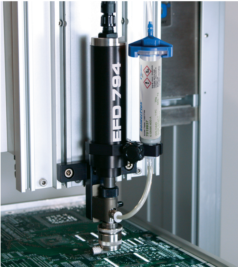
Valve à vis sans fin déposant de la pâte à souder EFD.
