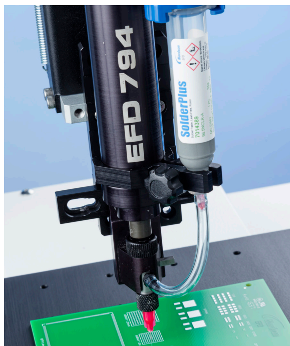
La valve à vis sans fin 794 applique de la pâte à souder sur une carte de circuit imprimé.
