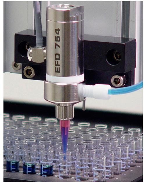
Ventil 754V-SS zur Dosierung von Flüssigkeit in Fläschchen.
