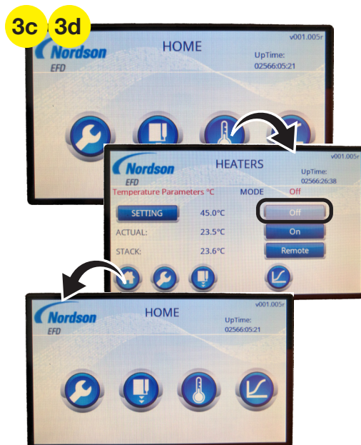
Apagado del controlador del calefactor y regreso a la pantalla de INICIO
