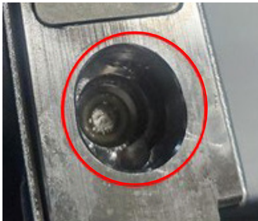
Ejemplos de actuadores de válvula Pulse con contaminación por adhesivo UV en la cavidad de la varilla de empuje
