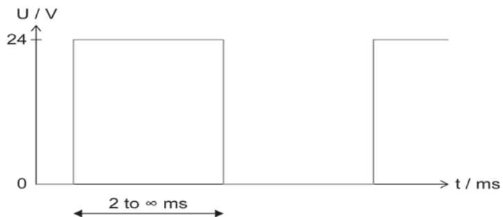
リキダイン P-Jetバルブのオシログラム (バルブ出力)
