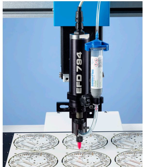
Válvula de broca 794 e robô aplicam pasta de solda a um dispositivo de deteção de incêndio.
