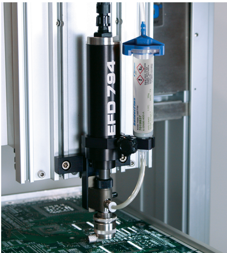
A válvula dosificadora de broca 794 dispensa pasta de solda EFD.
