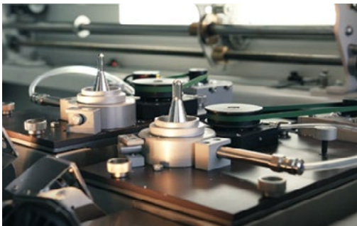
Doppelte Löt-düsen und Löttiegel
