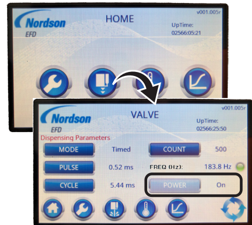
標準TouchコントローラのVALVE画面を 図示
