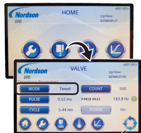
標準TouchコントローラのVALVE画面を図示
