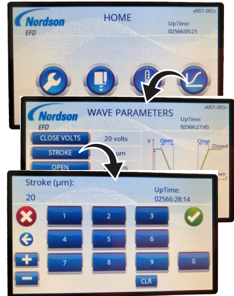
実行中のSTROKE設定の調整画面です(Touch XPコントローラ)
