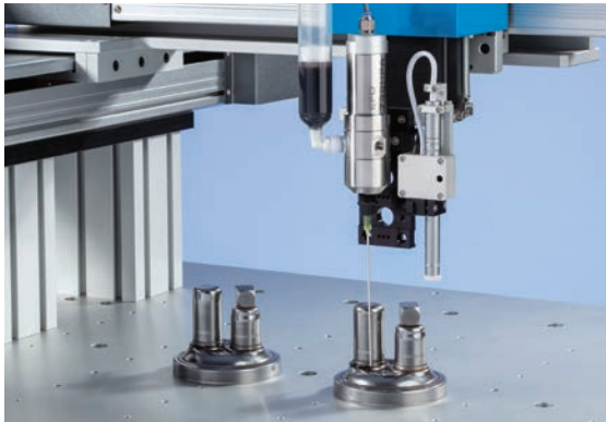
736胶阀将润滑脂点涂至汽车燃油泵阀盖上。
