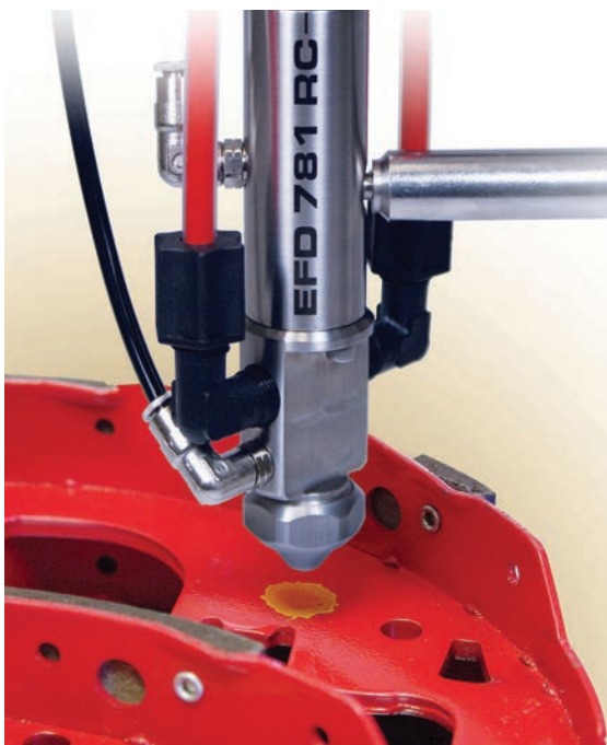
781RC再循环喷阀可使颜料保持悬浮状态。
