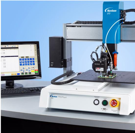
PROPlus系列自动点胶系统具有同类产品中最佳的位置可重复性, 误差在 $\pm 0.003$  毫米 (3微米)以内。
