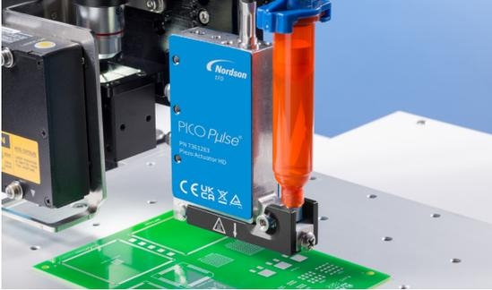
PICO Pulse<sup>®</sup>喷射阀能够以业内领先的速度和精度进行点胶。
