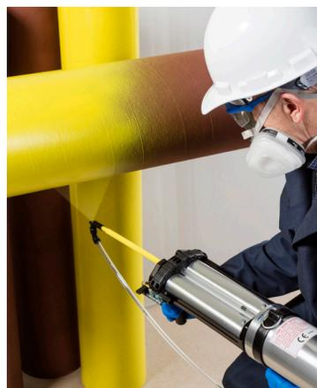
Il sistema a spruzzo HSS è in grado di spruzzare vernici a bassa viscosità senza problemi.
