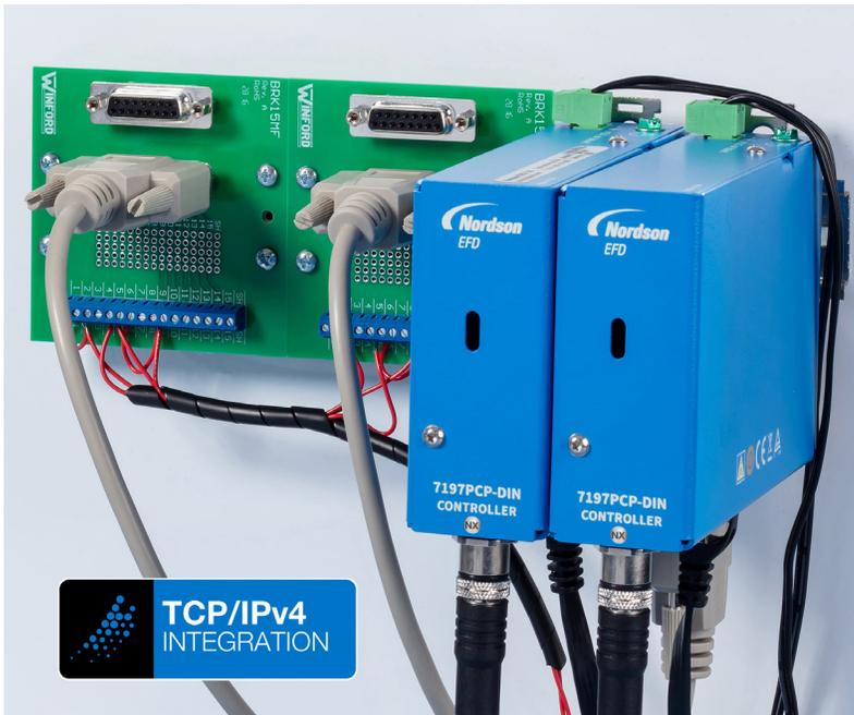
7197PCP-DIN-NX 控制器通过以太网结合NX 协议，用于智能工厂集成。
