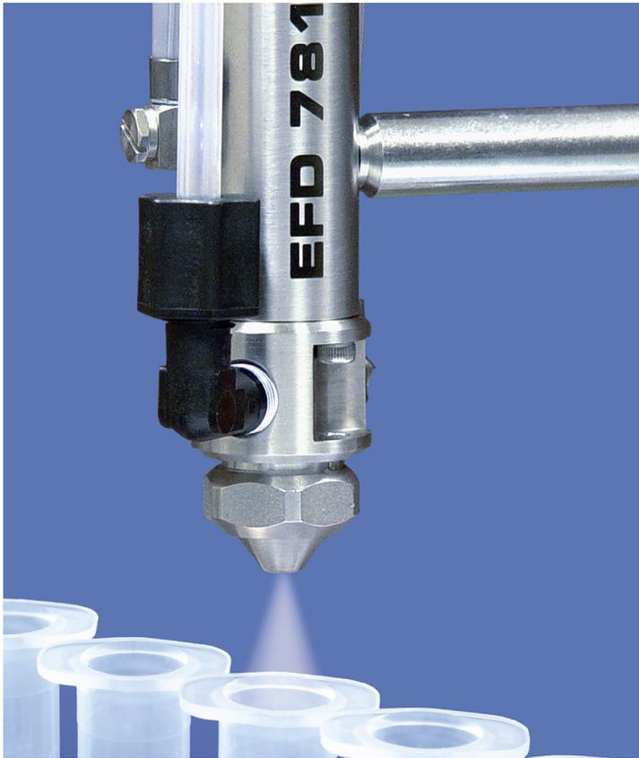
La válvula de pulverización 781S utiliza tecnología de bajo volumen y baja presión (LVLP) para aplicar una capa delgada de aceite de silicona dentro de las jeringas médicas.
