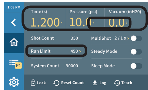
Änderbare Einstellungen auf dem Startbildschirm: Zeit, Druck, Vakuum, Programmzyklusgrenze und MultiShot
