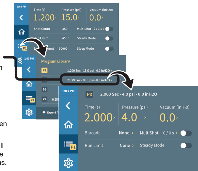
Bearbeitung von Programm 3 (P3) auf dem Bildschirm mit den Programmdetails, während Programm 1 (P1) noch das aktive Programm ist
