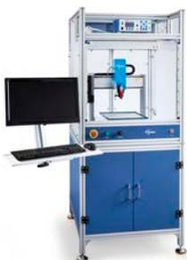
Gli involucri di sicurezza di Nordson EFD si integrano perfettamente con la nostra linea completa di sistemi di dosatura automatizzati. Caratterizzati da comandi di dosatura esterni, barriera fotoelettrica di sicurezza, scatola di comando elettrica interna e da portacavi per un'installazione più rapida e sicura, questi involucri conformi alle direttive CE sono anche pienamente conformi alla Direttiva macchine dell'Unione Europea 2006/42/CE.
