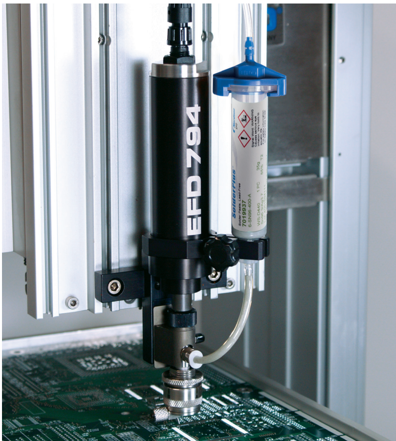
794螺杆阀点涂诺信EFD焊锡膏。
