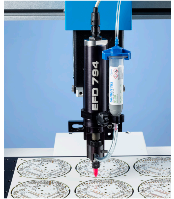
794螺杆阀搭载点胶平台，在火警探测器上点涂焊锡膏。
