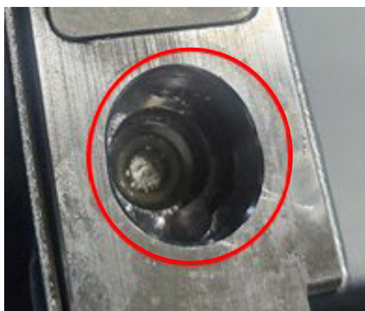
Esempi di attuatori per valvole Pulse con contaminazione di adesivo UV nella cavità dell'asta di spinta
