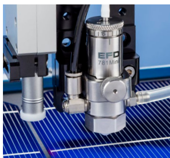
精密喷涂控制能够改善太阳能电池单元之间的连接工艺。
