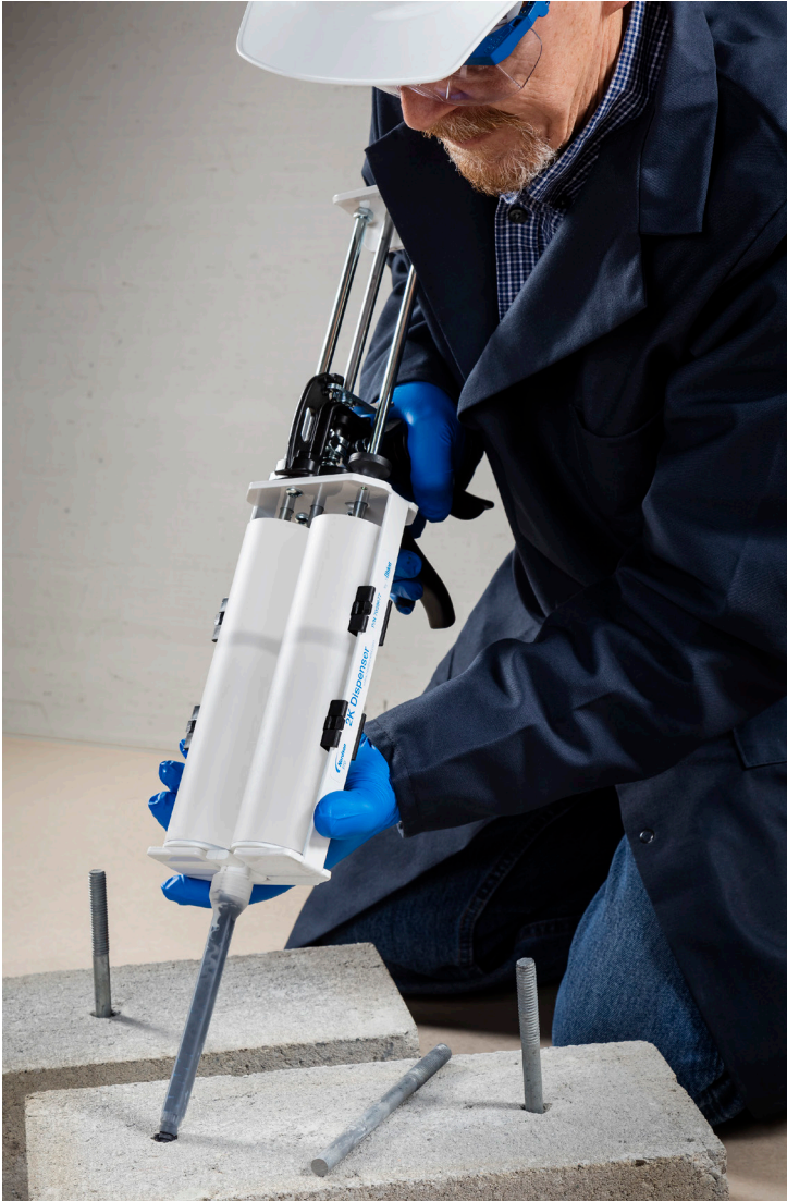
Portátiles y ligeras, las pistolas dosificadoras manuales 2K son ideales para el anclaje químico.
