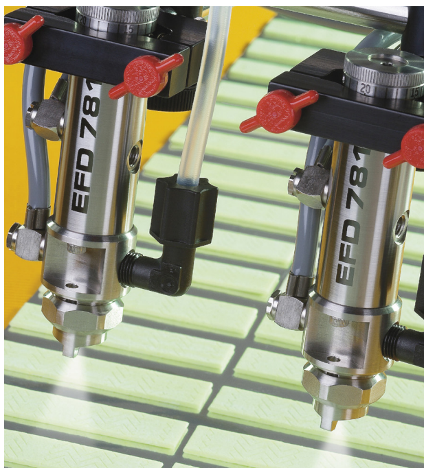
Valve 781 pulvérisant de la pâte à sucre sur de la gomme
