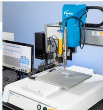
对于这项应用，我们推荐了 PROPlus 系列平台。这是我们最精密最先进的自动点胶系统，其设计旨在简化使用。它配备了我们独特的 DispenseMotion™ 软件，与摄像头无缝集成。高分辨率 CCD 智能摄像头采用全局快门，以消除平台操作时的任何模糊或扭曲。它还配有镭射高度检测（参见下图）来确定高度变化并自行调节，因此具有更高的精度。
