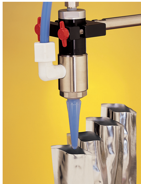
La valve 725HF-SS remplit les sachets de lotion.
