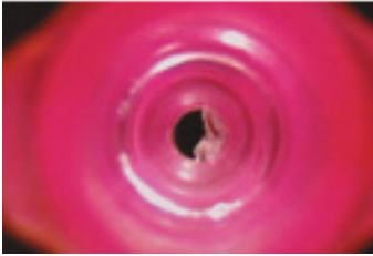
Les « bavures » à l'intérieur de l'embase des aiguilles de qualité inférieure restreignent le débit des fluides.
