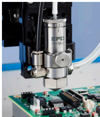
オーバースプレーゼロによる部品汚染の防止
