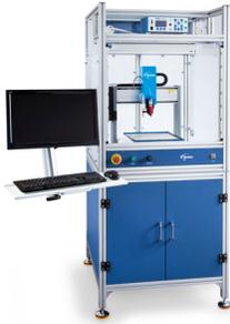
Gesicherte Schutzeinhausungen von Nordson EFD integrieren sich nahtlos mit unserer gesamten Reihe an automatisierten Dosiersystemen. Das System beinhaltet externe Dosierkontrollen, eine Sicherheitslichtschranke und einen internen Verteiler und Kabelkanäle für schnelleres, sicheres Setup. Diese CE-konformen Einhausungen sind außerdem vollkonform mit der EU Maschinenrichtlinie 2006/42/EG.
