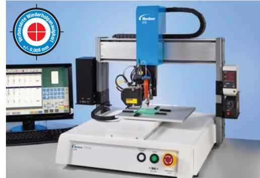
Integrierte Vision-Kamera und Lasersensor machen die PRO Series zu einer vollständigen Automationslösung.
