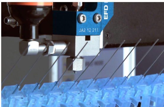
Liquidyn® P-Jet バルブはニューマチックジェットイングシステムで3 nL という微細塗布を実現
