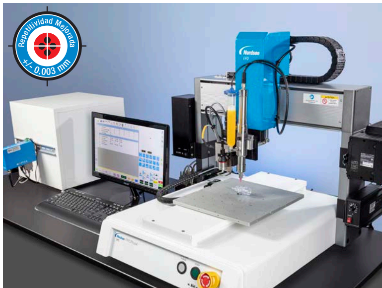
La serie PROX funciona con un motor lineal sin contacto que mejora la velocidad de accionamiento y reduce las necesidades de mantenimiento.
