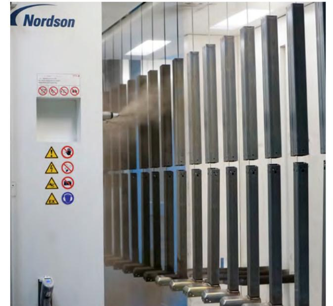
Die weiche Pulverwolke des Encore HD Sprühsystems sorgt für eine vollständige Prozesskontrolle.
