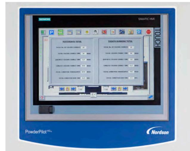
Bis zu 10 Farbwechsel pro Schicht – die vom System aufgezeichneten Farbwechsel-Daten sind Teil des Toolkits zur Überwachung der Betriebseffizienz und dienen der kontinuierlichen Verbesserung
