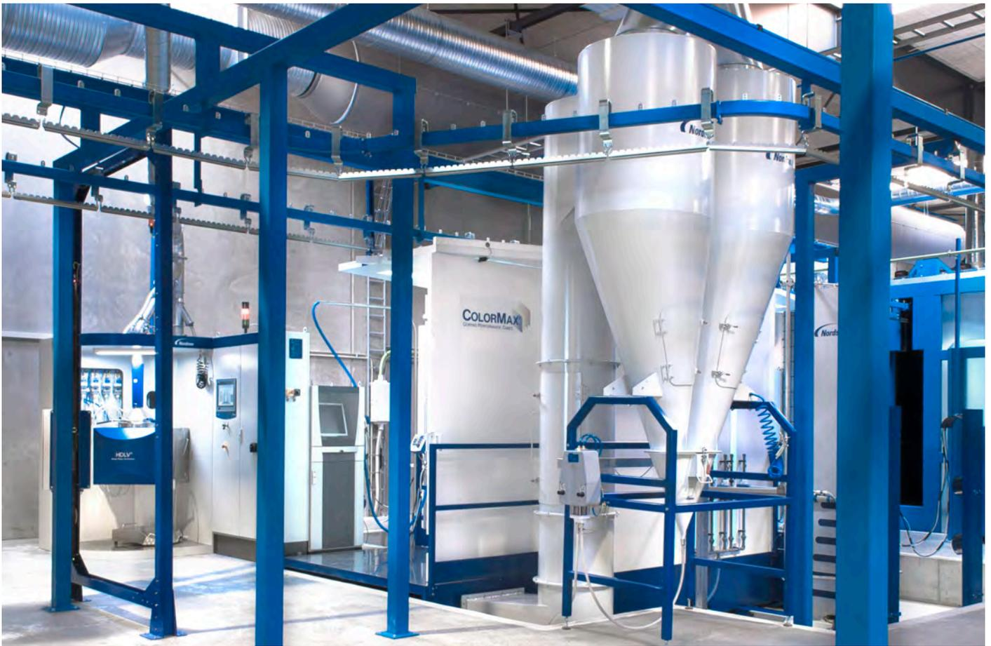
Das Schnellfarbwechselsystem umfasst das Spectrum HD Pulverzentrum mit PowderPilot Steuerung, ColorMax<sup>3</sup> Kabine und sieben Encore HD Automatik-Pulverpistolen
