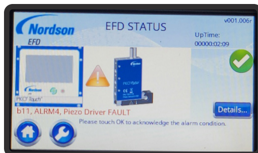
系统显示警报代码 (在本示例中为 b11 004, 压电驱动器故障)。
