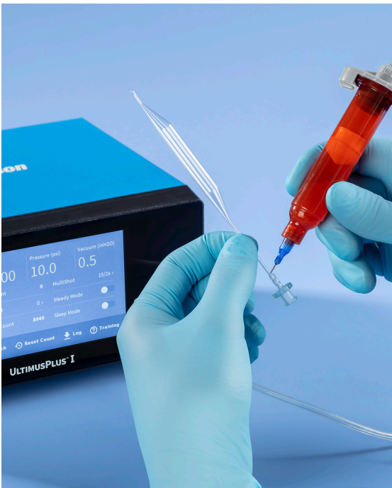
UltimusPlus 简化了导管粘接应用的设置,同时为更高的产品质量提供了更好的工艺控制。
