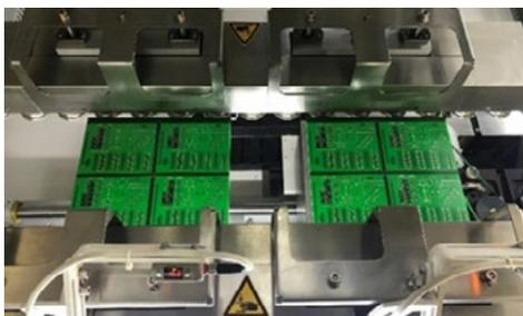
Lötén von panelisierten Leiterplatten mit 2-Segment-Konfiguration
