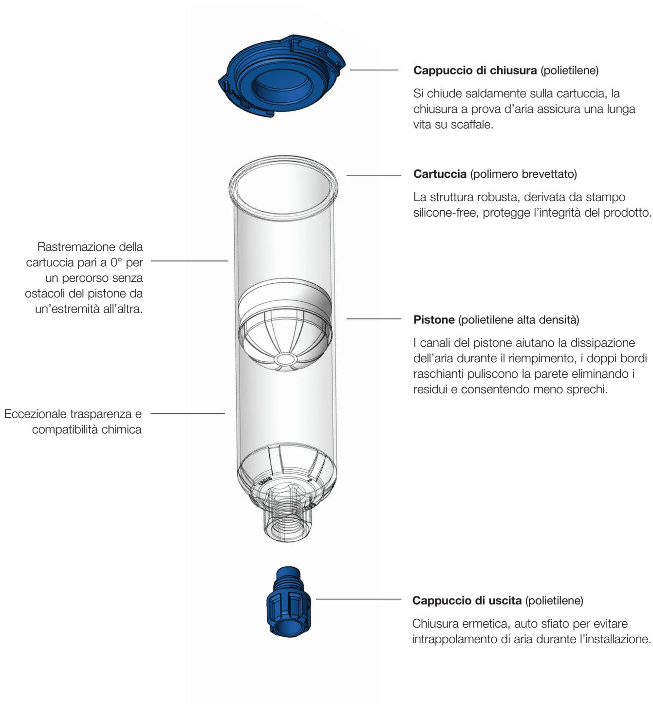
Le cartucce sono prodotte da un polimero robusto, trasparente, conforme a FDA e RoHs, con pareti ZeroDraft che mantengono il diametro interno uniforme su tutta la lunghezza della cartuccia, consentendo al pistone una corsa senza ostacoli.
