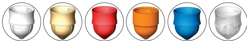
Stampati da polietilene inerte, i pistoni brevettati SmoothFlow vengono inseriti nei serbatoi siringa, da un lato per evitare che l'aria crei un tunnel all'interno dei fluidi di alta viscosità e dall'altro per consentire una gestione più semplice e sicura dei fluidi di bassa viscosità.
