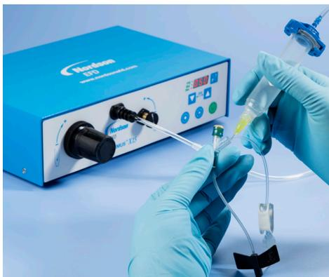
Dosatura di un solvente a bassa viscosità su dispositivi medici.
