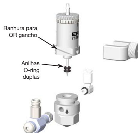
Posição correta de instalação para a tomada do ar da ponteira
