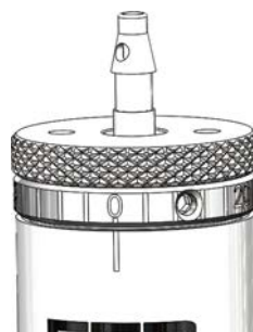
Zero (0) e marca de referência alinhados, indicando que o controlo do curso foi bem calibrado
