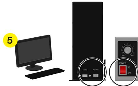
6. Schalten Sie die Stromversorgung des Roboters aus.
