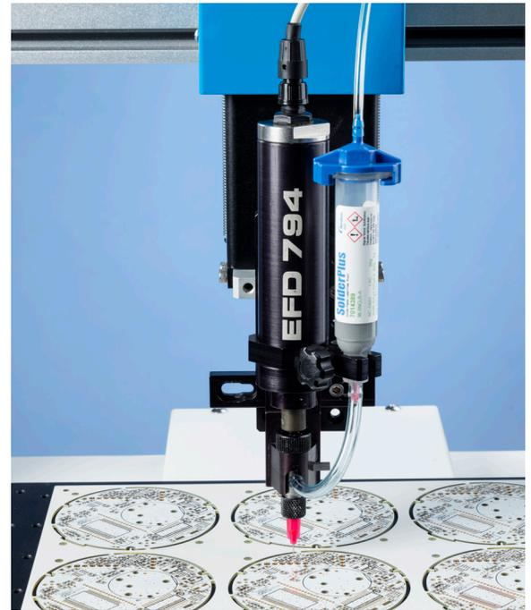
Valvola a coclea 794 e robot applicano pasta saldante su un dispositivo di rilevamento incendio.
