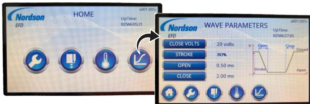
Écran des paramètres des courbes (Wave Parameters) sur le contrôleur *Touch* standard (les unités de STROKE (Course) sont définies en pourcentage de CLOSE VOLTS (Tensions de fermeture))
