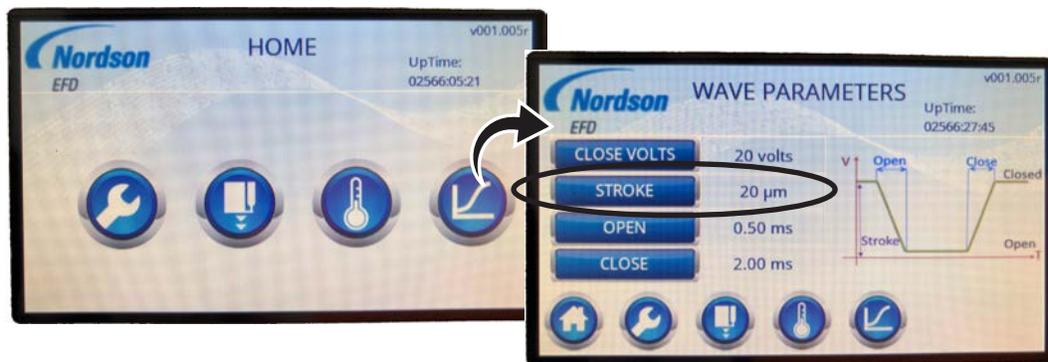
Écran WAVE PARAMETERS (Paramètres des courbes) sur le contrôleur Touch XP (les unités de STROKE (Course) sont définies en microns)
