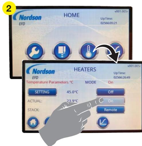
*Mettre sous tension le contrôle du système de chauffe*
