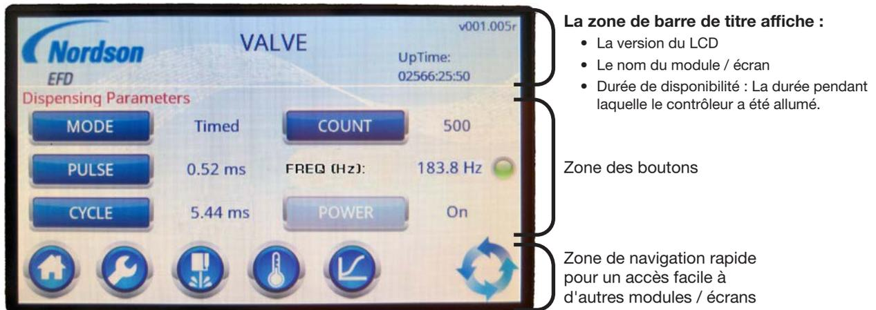
Structure d'un écran du contrôleur Touch (écran VALVE de Touch standard illustré ; le numéro de version du LCD et les valeurs de la disponibilité ne sont que des exemples)
