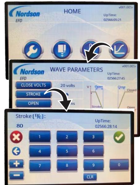
Réglage du paramètre STROKE du profil de courbe activé (Contrôleur *Touch* standard)
