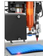
Lasersensor zur Höhenerkennung
